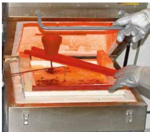
Piec do wtapiania GFM 1425 z pokrywą sterowaną siłownikiem
