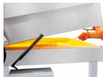
Łączenie szkła w piecu do wtapiania GF 240
