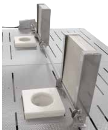
Kłapa powietrza wylotowego w ramach wyposażenia dodatkowego
