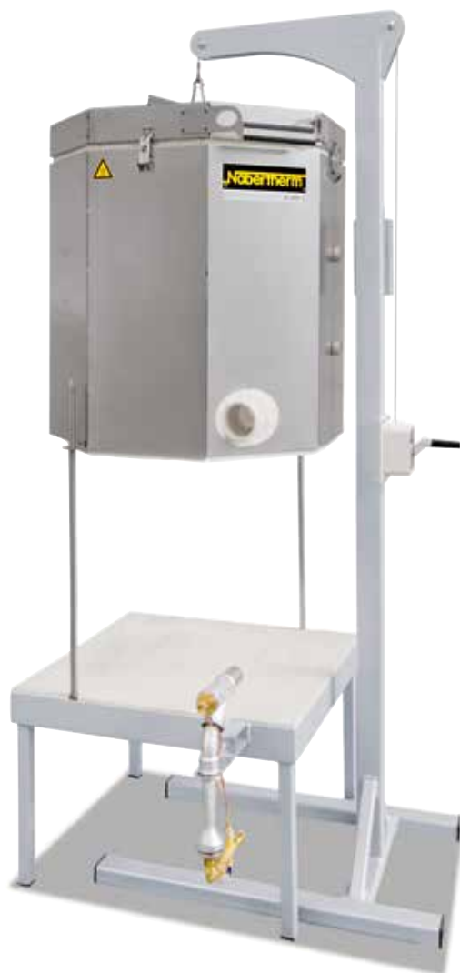
Piec RAKU 100 z palnikiem gazowym i stojakiem do podnoszenia wyposażonym w napęd korbowy
