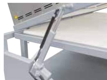
Automatyczne otwieranie kołpaka przy użyciu wrzeczona z napędem elektromechanicznym, w ramach wyposażenia dodatkowego
