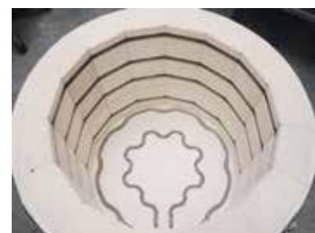
Elementy grzewcze w dnie w ramach wyposażenia dodatkowego
